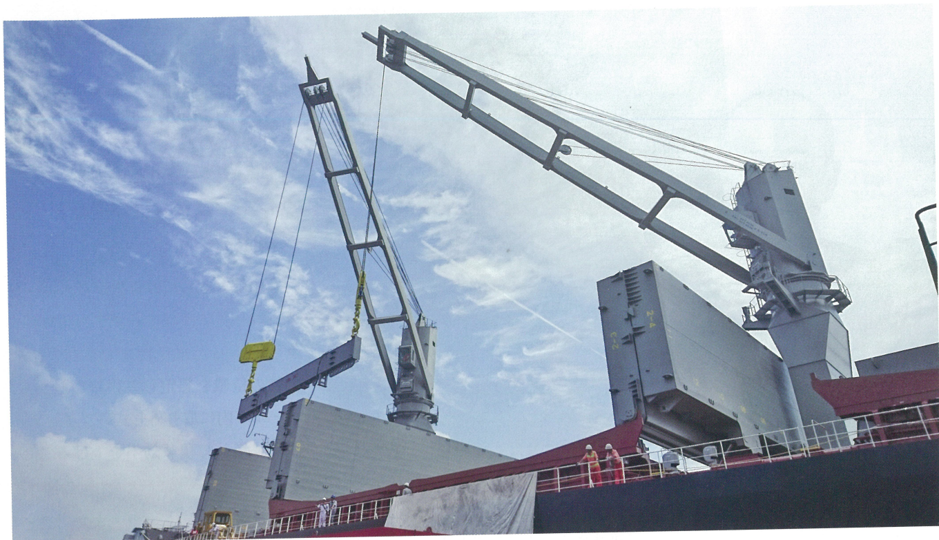
40トンクレーン
